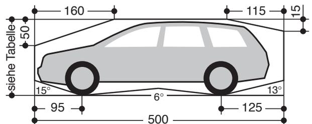
\* Die Mindestbauhöhe ist das lichte Maß, gemessen von der fertigen Fahrbahn bis zur Unterkante der Decke.
