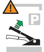
Senken Sie Pkw mit hydraulischer Höhenverstellung vollständig ab!
